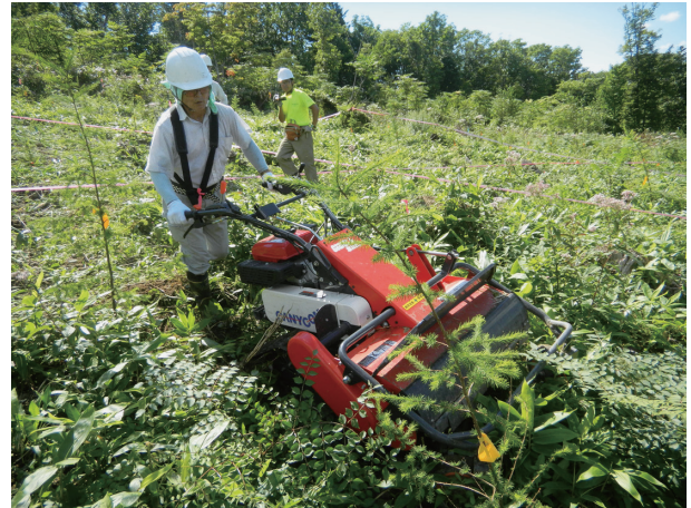
写真-9 歩行型刈払い機による下刈り作業 (筑水キャニコム ブッシュカッタージョージ Jr. 草薙)
