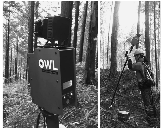
図-1 レーザー計測装置OWL 1脚式、軽量(4kg)で片手で支えられる
