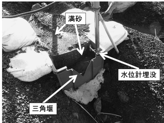
写真-3 対照区の満砂した三角堰
