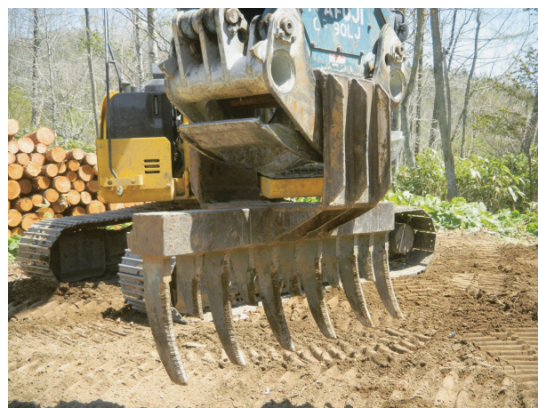
写真-3 グラップルローダ用に自作されたレーキ爪
