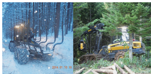
図-2 先進型林業機械 ポンセ社 Gazelle (左) と Beaver (右)
