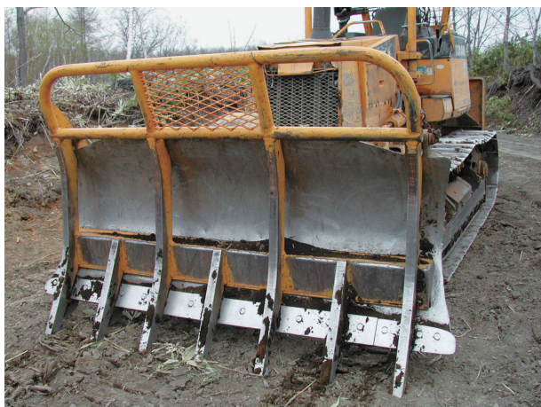
写真-2 レーキ爪装着ブルドーザ
