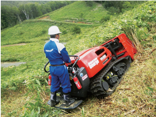
写真-8 乗用型刈払い機による傾斜地での地拵え作業 (筑水キャニコム ブッシュカッタージョージ)
