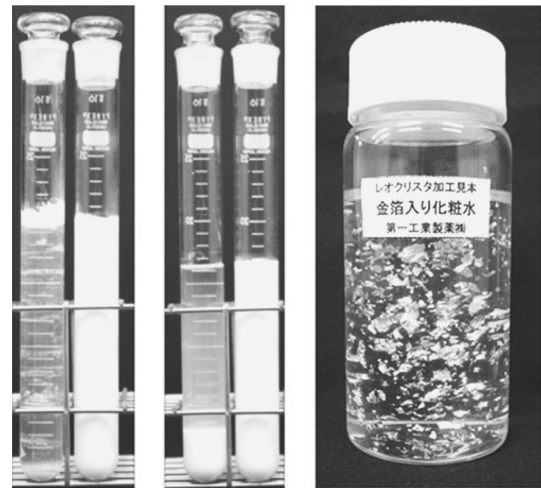
図-3 TOCNF (固形分濃度 0.2 wt%) による分散安定効果 左から酸化チタン、炭酸カルシウム、金箔。TOCNF 無添加だと、酸化チタンと炭酸カルシウム (それぞれ左側の試験管) は均等に分散せず沈殿する
