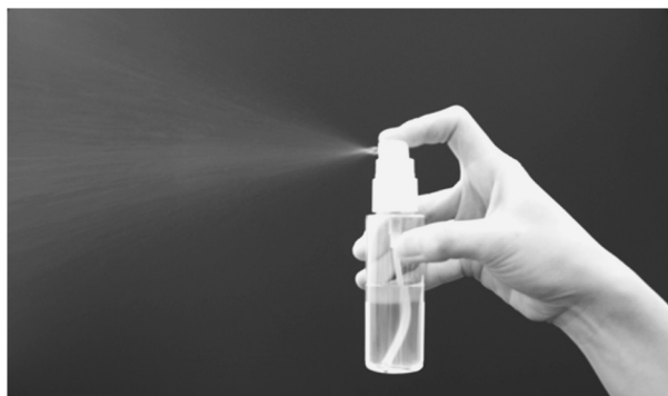
図-5 0.5wt%TOCNF のスプレー噴霧
