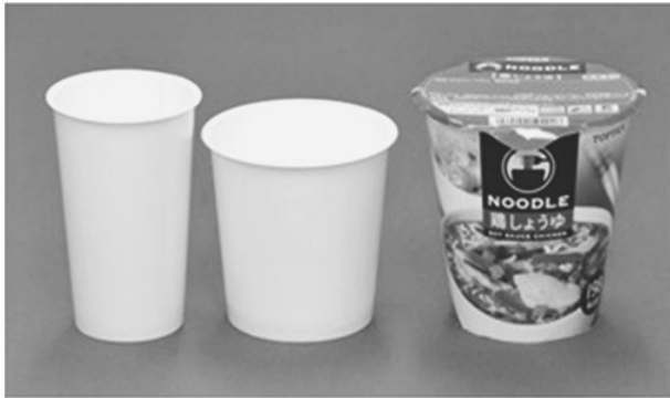
図-2 CNF を用いたバリア紙カップのサンプル (左) と層構成図 (右)
